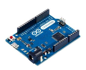
Для обработки сигналов, поступающих с датчика мы будем использовать контроллер Arduino Leonardo
