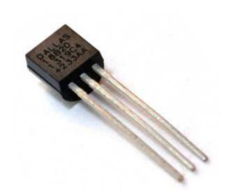
В качестве измерителя температуры мы будем использовать датчик – DS18B20, использующий интерфейс 1-Wire для связи с Arduino
