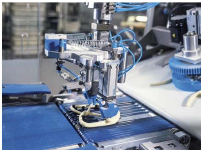
Чуткая пневматика: чувствительные рабочие органы робототехники аккуратно и крепко подхватывают за концы колбаску из теста.
