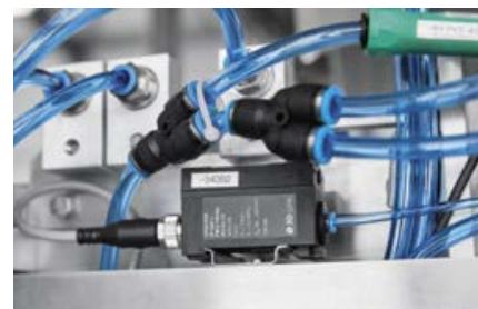
Датчик давления Festo SPAU с IO-Link® измеряет необходимый объем воздуха для закачивания в пакеты.
