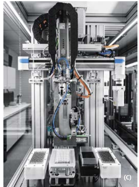
(А) Электромеханический суппорт EGSC перемещает пипетирующую головку вниз, чтобы добавить жидкость в микротитрационные планшеты на нескольких станциях промывки.
