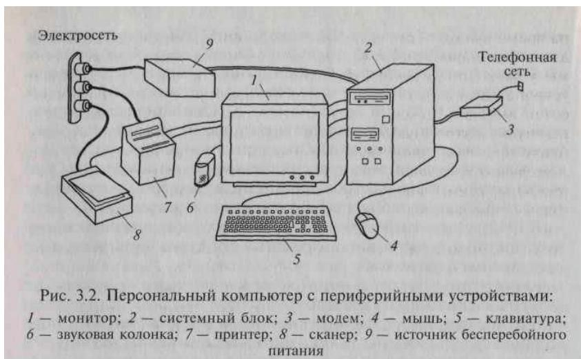
Рис. 3.2. Персональный компьютер с периферийными устройствами:
