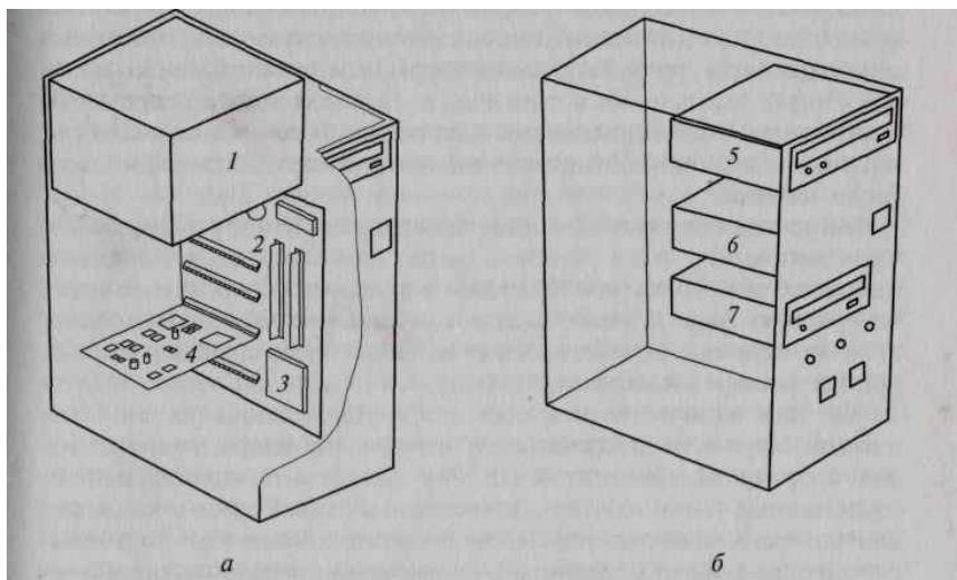
Рис. 3.3. Системный блок персонального компьютера:
