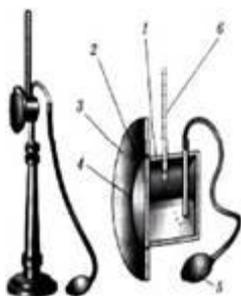
Рис. 4. Конденсационный гигрометр ([Источник](#))
