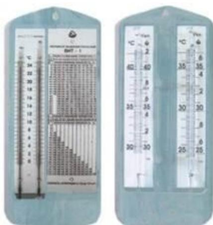
Рис. 6. Психрометр ([Источник](#))
