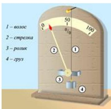
Рис. 5. Волосной гигрометр ([Источник](#))
