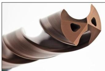
**Сверло одностороннего реза.** Применяется для сверления отверстий, к которым предъявляются повышенные требования в отношении точности. Сверла одностороннего резания имеют опорную плоскость и две режущие кромки, расположенные с одной стороны от центра.
